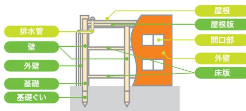
構造耐力上主要な部分 雨水の浸入を防止する部分
