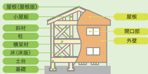
木造軸組工法の木造住宅の場合
