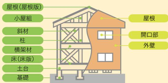
構造耐力上主要な部分 雨水の浸入を防止する部分
