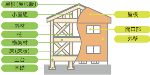
木造軸組工法の木造住宅の場合
