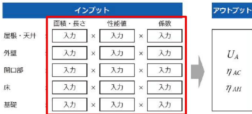
図 3.1.2 標準計算ルートの外皮性能計算のイメージ
