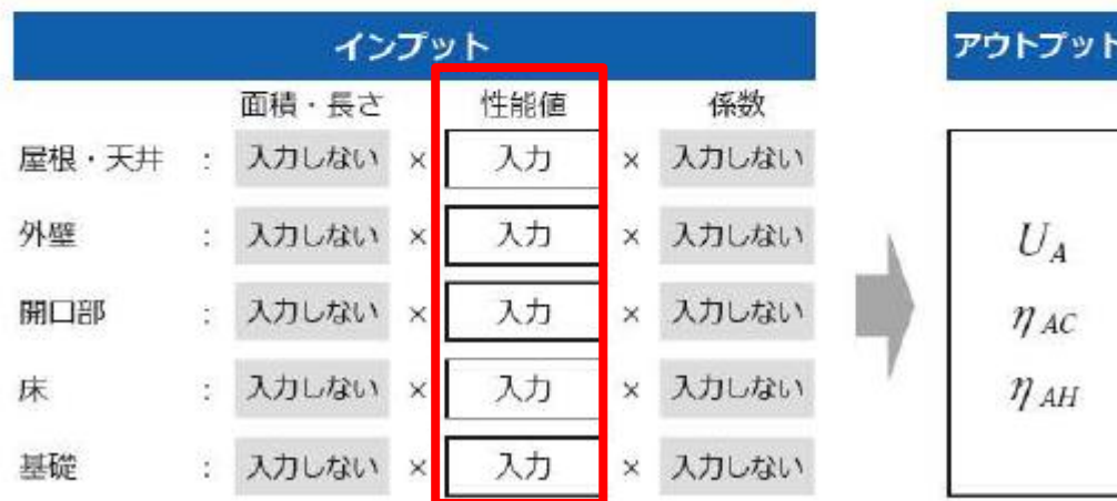
図 3.1.4 簡易計算ルート【外皮面積を計算しない方法】の外皮性能計算のイメージ
